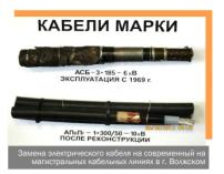
прежнего), при этом потенциальный срок эксплуатации такого кабеля составляет до 50 лет за счёт надёжных материалов изоляции и оболочки. Кроме того, на новых кабельных линиях только две соединительные муфты вместо прежних семи, что снижает возможность аварийных разрывов и также повышает надёжность и срок службы кабеля.
